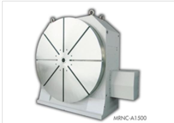
潭兴四轴转台工作技术特点（四）潭兴第四轴分度盘的重要附件之一，它可以在铣床工件加工过程中进行分度钻孔、铣削或圆周切削操作。下面就简单的介绍一下中国台湾潭兴分度盘的操作方法：1. 操作前请确定完成选择钮定位；2. 操作杆完成定位后，需要将操作杆还原，当分度头不转动时，则说明选择钮操作有误，需要转回原位重新操作；3. 分度盘适合铣床、钻床简易快速分割使用，操作过程可一次性完成松夹，分度，定位，操作杆还原；4. 只要轻转分度头周围的选择钮就可进行分度，请注意选择钮凹槽向下为定位位置，凹槽向上跳跃位置；一般的铣床分度盘都是手柄摇动四十圈分度盘会转动三百六十度从而在摇动十圈时，分度盘的数值是九十度。分度盘数字计算常使用四十作为分母除去分度数，计算结果可以被整除的就是需要转动的圈数。杭州千岛拓新，专业的中国台湾电脑数控分度盘供应商！无锡配件电脑数控分度盘供应商
