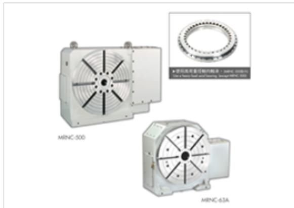
潭兴四轴转台工作技术特点（二）潭兴第四轴分度盘技术说明1. 采用强度高的**FC30**铸铁制造。2. 适合铣床或其它特殊机械作分割切削使用。3. 新型的主轴锁固系统，较传统双边压板型，锁固更强，切削更稳固。4. 可做360度过转，把手回转一圈4度，较小刻度划10秒。5. 可做水平及垂直方向使用。6. 可做附加特别附件：蜂巢板及尾座。7. 减速比例1:60。潭兴第四轴分度盘中的编码器的作用相当于手动分度盘动作时摇动人员的眼睛，当人员看到需要刻度到达就停止摇动。那么编码器是始终记录电机转动过的角度。当到达预设角度也就是编码器输出和预设数据相同的脉冲数据的时刻电机停止转动。
